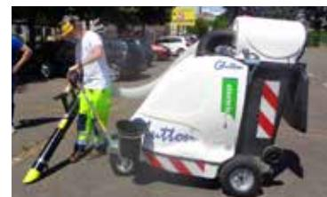
Cet engin dénommé « Glutton » est un aspirateur autotractionné à moteur électrique qui absorbe tout type de déchets urbains (carton, bouteille en verre, déjection, feuilles...).
